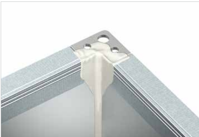
9. Abdichtmaßnahmen - Dichtmasse (z.B. Gebhardt-MAXX, siehe S. 25) mit der Kanalinnenseite annähernd bündig aufspritzen. Bei Profilen mit integrierter Dichtmasse (BUTYL/GEL) ist KEINE Abdichtung entlang der Profillängskante notwendig. Falzabdichtung nicht vergessen!
