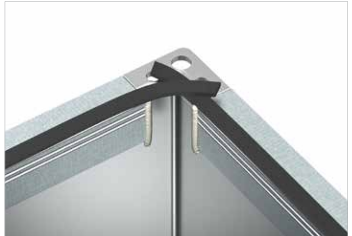
11. Abdichtmaßnahmen bei der Montage - Dichtungsband bündig mit der Kanalinnenseite so aufkleben, dass die Enden im Eckbereich wie abgebildet überlappen. Empfohlenes Dichtband: 20er Profil=15x4 mm, 30er Profil=20x4 mm, 40er Profil=25x4 mm (siehe S. 34)
