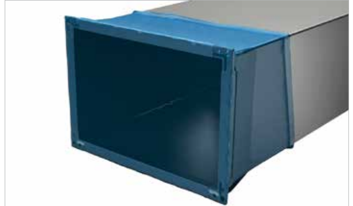
10. Transportverpackung - Vor dem Transport zur Baustelle empfiehlt es sich, die Öffnungen der Kanalbauteile mittels selbstklebender Folie zu verschließen (siehe S. 26).
